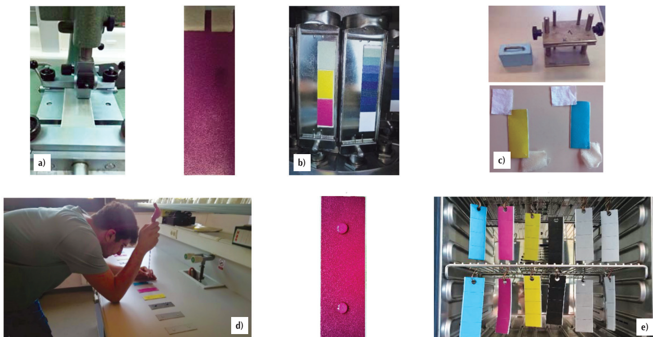
Slika 2. Ispitivanje postojanosti otiska na: a) suho i mokro trljanje, b) djelovanje umjetnog svjetla, c) djelovanje vode, d) vodene kapi, e) ubrzano starenje djelovanjem topline
